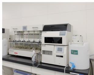
溶出試験機。有効成分が体内で溶けていくスピードをin vitro(試験管内)で調べる
