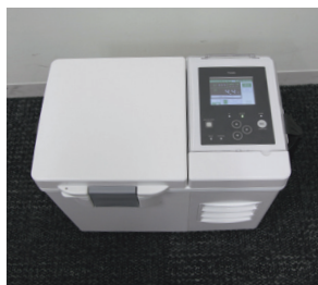
電子冷却式搬送装置「サルム」(左は本体)。内部電池と外部電源の両方で使用可能。蓋を開けるなどして庫内温度が変わったときはアラームが鳴る。庫内温度は連続1か月以上記録され、データ管理できる
