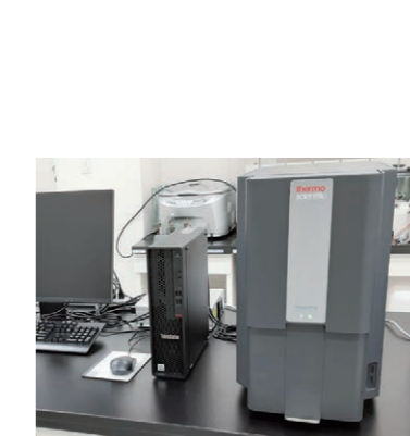
卓上走査型電子顕微鏡 (SEM-EDS) 2021年3月に導入された新しい分析機器。波長の短い電子線で薬を観察し、含有されている元素を分析する
