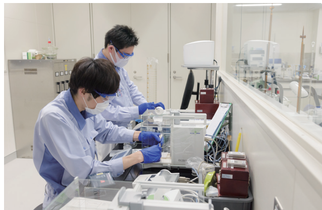
天秤室。標準品や試薬の計量を行なう。セミマイクロ天秤は0.00001g単位を測ることができる
