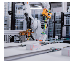
(右)ピース品のピッキングロボットは26台が稼働。(上)商品を17方向から撮影することで商品の形を正確に把握し、的確にピッキングする
