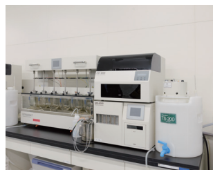
溶出試験機。有効成分が体内で溶けていくスピードをin vitro（試験管内）で調べる
