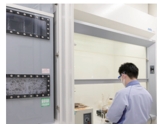
ドラフト室。試験過程で発生した有害な蒸気を外部に出すことなく、吸収し、処理する
