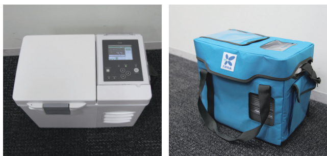
電子冷却式搬送装置「サルム」(右はカバー付き)。TBCから病院やクリニックに搬送し、そのまま保管可能。蓋を開けるなどして庫内温度が変わったときはアラームが鳴る。庫内温度は連続1か月以上記録され、データ管理できる
